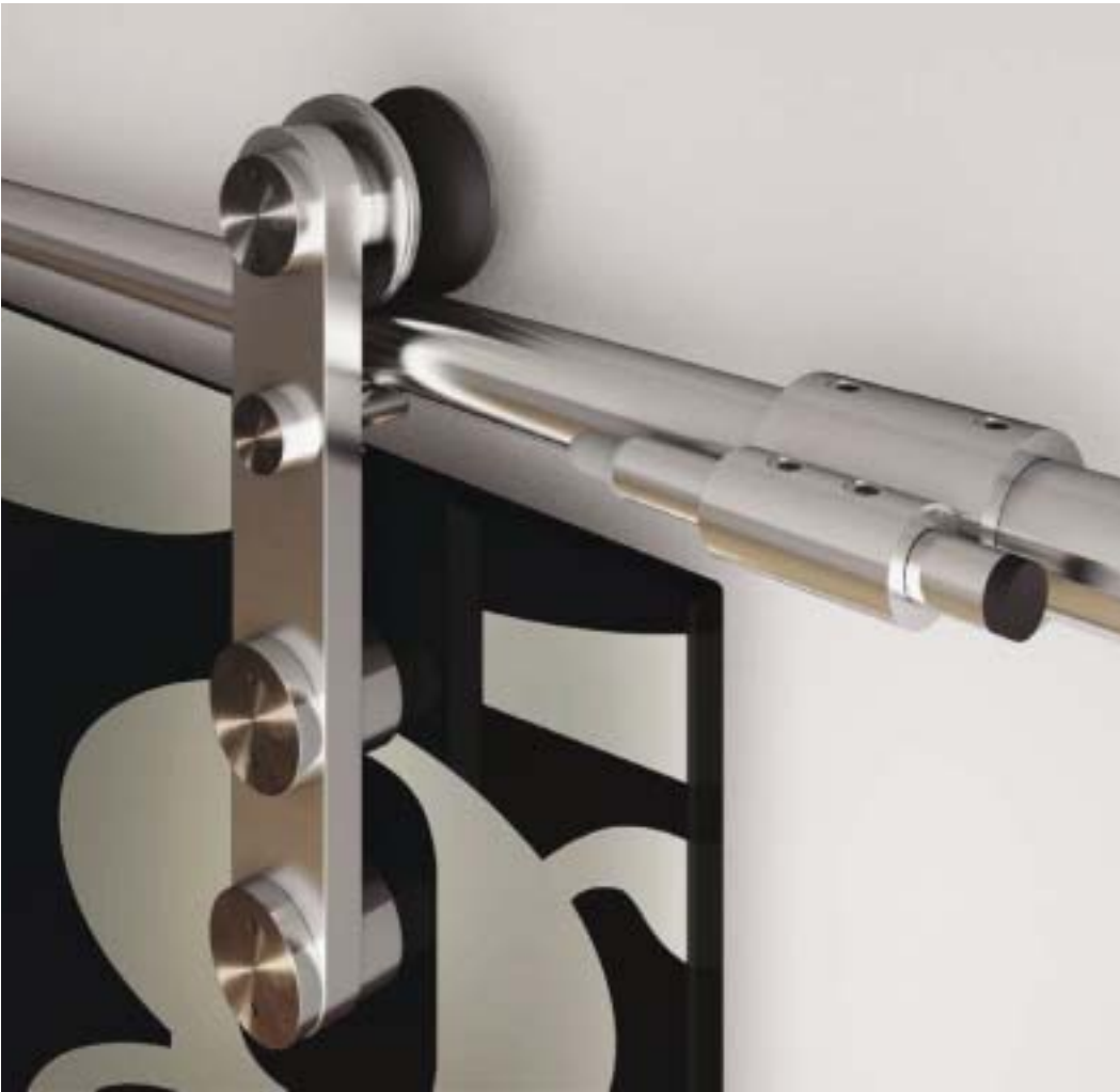
staffa con perno di sicurezza, fine-corsa coassiale regolabile con ammortizzatore stirrup with safety kingpin, fully adjustable coaxial stop connector with shock absorber
